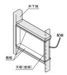
リモコンボックスを横向きに取り付ける場合は 配線と木下地にご注意ください。 配線を避けるために天板(底板)が 側板の奥行より短くなっています。
